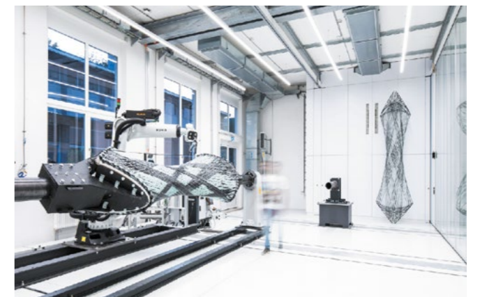
Роборука, яка переплітає волокна між собою Джерело: ICDITKE University of Stuttgart
